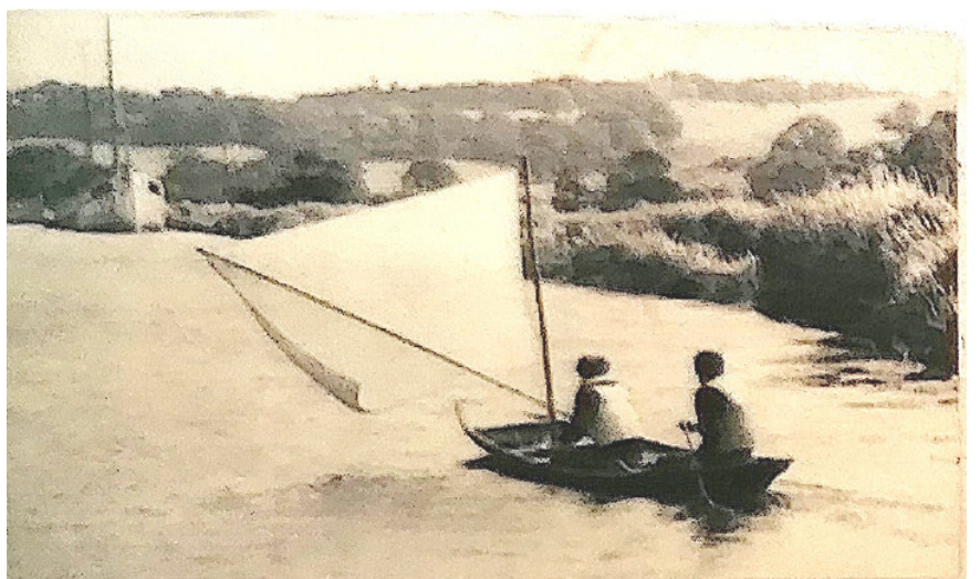
La gauge à voiler est souvent positionnée à gauche mais, en fonction de l'allure du vent, elle peut être gréée à droite. Pour aider le bateau à virer pour bien prendre le vent, le pêcheur s'aide d'un aviron qui lui sert aussi d'aviron de gouverne. Ici, les gaules ne font guère plus de 2,20 m. Col. Ellébore, source inconnue.
