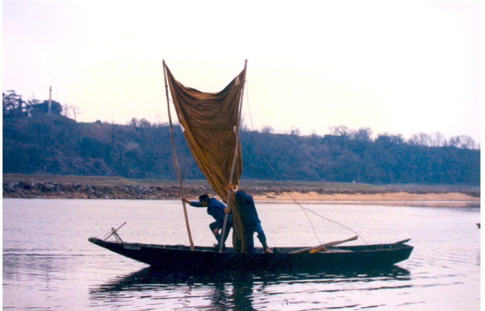
Les ventières sont maintenues par une estrope de corde ou d'osier, «l'étrou». Cl. D. Le Vraux/Ellébore, 1998.
